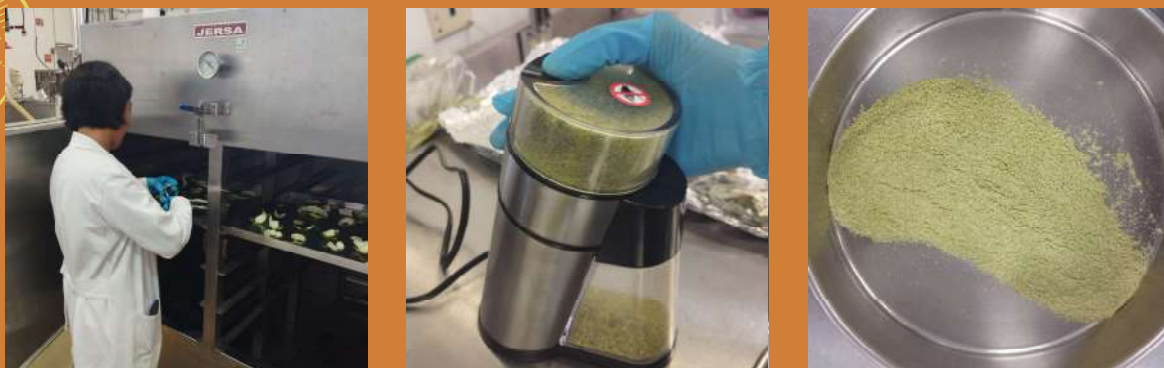
Figura 2. Proceso de secado por charola de cítricos (izq a der): secado; molienda, aspecto de la harina obtenida.
