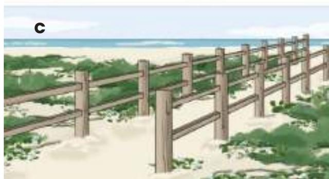
**Figura 16.** Cercos de protección de la vegetación de dunas costeras. A) Cercos de madera con cuerda; B) Cercos de postes de concreto con alambre de acero inoxidable, C) Cercos de postes y travesaños de madera.
